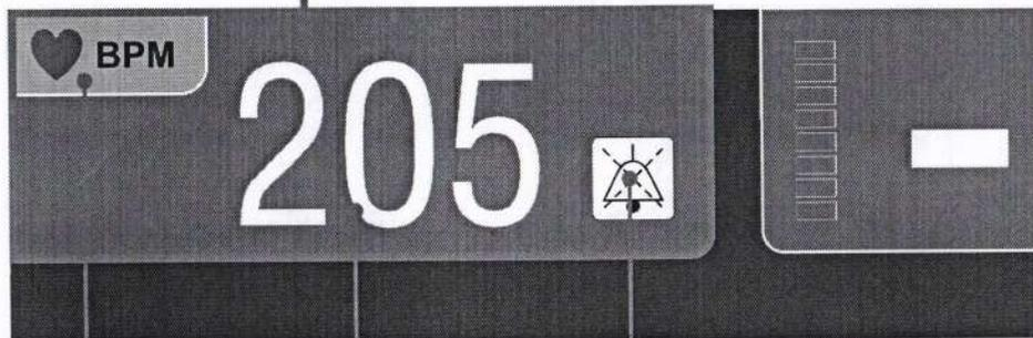
1 - Símbolo de ECG. O ícone de ECG representa um coração que expande indicando a detecção do pico da onda "R" do ECG.
