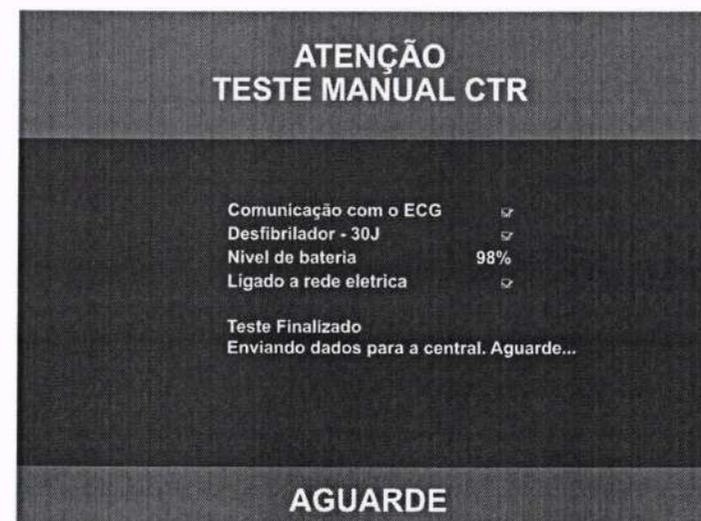
Não é possível interromper o teste manual. Após concluído o teste, o equipamento transmitirá os dados coletados à Central CTR. Neste momento, não é possível desligar o aparelho. Caso a conexão com a Central CTR não possa ser estabelecida, o aparelho cancelará o envio de dados após 10 segundos. Após este procedimento, o aparelho salva os dados coletados e retorna ao modo definido pela chave rotativa do CardioMax.
