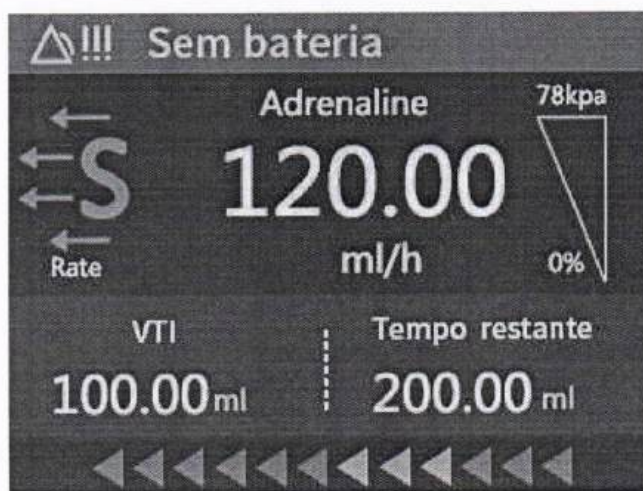
Figura 8-5 Alarme de falta de bateria
