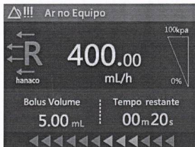
Figura 8-4 Alarme de ar na linha
