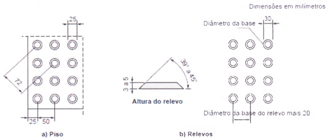
Figura 62 – Sinalização tátil de alerta e relevos táteis de alerta instalados no piso
