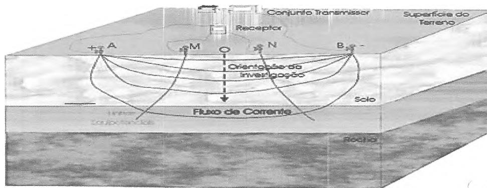
Figura 01 – Esboço do arranjo geoeletrico Quadripolar AMNB.
